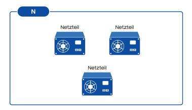
Ein Design mit dem Wert N bedeutet, dass das Display nur für den Fall eines Ausfalls bei Volllast ausgelegt ist und keine zusätzliche Redundanz zur Verfügung steht.
