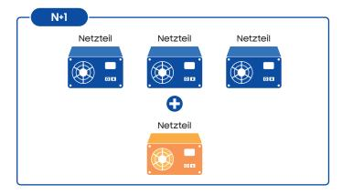
Ein Design mit dem Wert N+ bedeutet, dass eine zusätzliche Komponente hinzugefügt wurde, um ein Ausfallereignis zu verhindern. Typischerweise steht hierbei für je drei Netzteile ein zusätzliches zur Verfügung.
